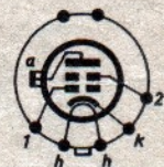
Sockelschaltung und Maße der Bm 35 R-2
